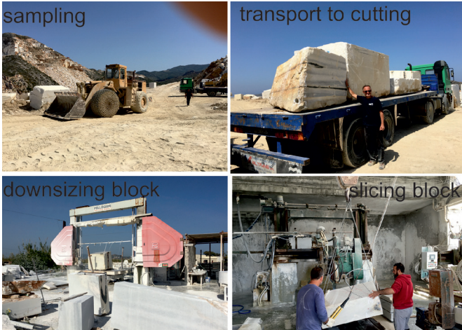
Abb. 2: Aufschlussmaßstäbliche Tomographie. Zwei Blöcke mit teilweise gefalteten Boudins wurden im Steinbruch ausgewählt, in die Sägerei gebracht und in 2 cm dicke Scheiben geschnitten. Danach konnte die Struktur hochauflösend in 3D kartiert werden.
